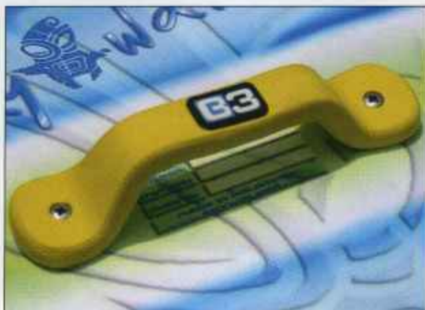
Der Grabhandle ist aus zwei EVA-Schichten geklebt. Zur Versteifung ist ein Aluminiumband eingearbeitet.
